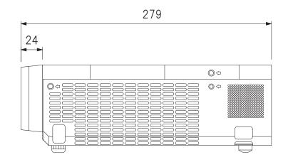
重量:約3.4kg 消費電力:320W 電源:AC100V
