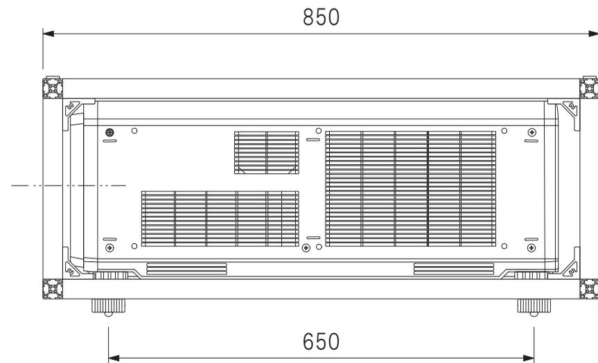
重量：約60.4kg(フレーム使用時)/約49kg(本体のみ)
